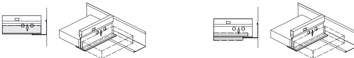
Pour la finition semi-encastree, la feuillure doit être exécutée sur le chantier.
